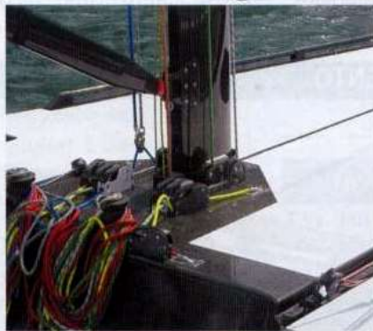
La torretta Harken (a sinistra) è il regno del randista: ospita anche il comando del trim tab. A destra, la "batteria" delle drizze.
