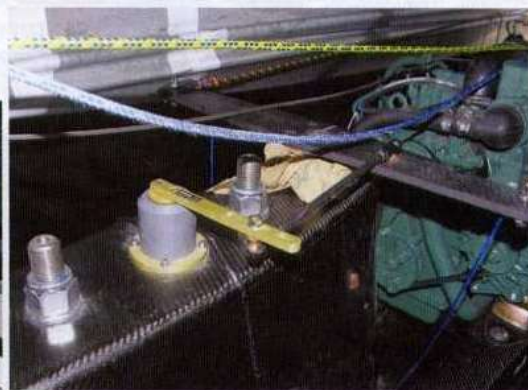
Sopra, abbiamo scoperto il comando interno del trim tab. Sotto, l'albero in carbonio con le crocette carenate in Kevlar: massima attenzione ai dettagli.
